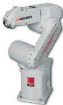
Los robots de brazo articulado disponen de conexiones para cables y aire comprimido alojadas en su interior.
